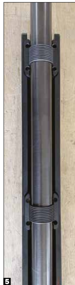
4 e 5. Alla base della chiusura "a cravatta" ci sono i 10 o-ring, in ognuno dei due punti di fissaggio azione-calciatura, che contribuiscono ad attenuare gli effetti del rinculo.
