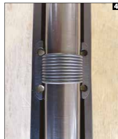
4 e 5. Alla base della chiusura "a cravatta" ci sono i 10 o-ring, in ognuno dei due punti di fissaggio azione-calciatura, che contribuiscono ad attenuare gli effetti del rinculo.
