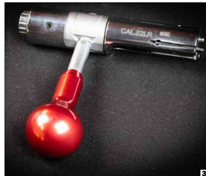
1, 2 e 3. Per ottenere l'otturatore, Pardini fa ricorso a un acciaio diverso rispetto alle altre parti, che insieme alla cromatura del corpo consente di ottenere una migliore scorrevolezza. Il percussore è a "ore 12", mentre nella parte posteriore c'è l'avvisatore di percussore armato.
