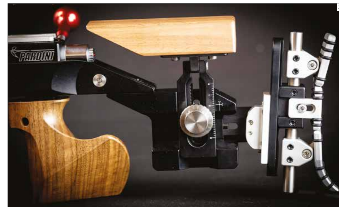
1. Lo scatto è uno dei punti di forza delle armi Pardini e, quindi, anche della Fr22. Si può regolare il peso tra 70 e 250 grammi, ma anche il peso e la corsa del primo tempo, così come peso e corsa del secondo tempo.
