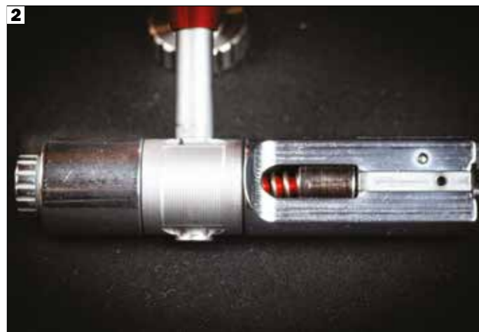
1, 2 e 3. Per ottenere l'otturatore, Pardini fa ricorso a un acciaio diverso rispetto alle altre parti, che insieme alla cromatura del corpo consente di ottenere una migliore scorrevolezza. Il percussore è a "ore 12", mentre nella parte posteriore c'è l'avvisatore di percussore armato.
